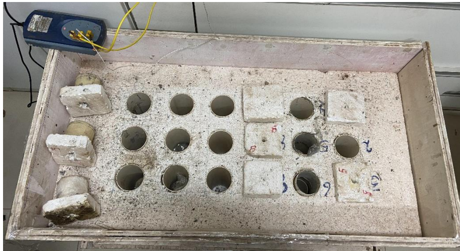
Figura 29 – Sistema utilizado para armazenar as amostras para o ensaio de termometria. Fonte: AUTORA, 2022.
