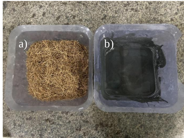
Figura 24: Materiais para a mistura, (a) fibras, (b) pasta de sílica. Fonte: AUTORA, 2022.
