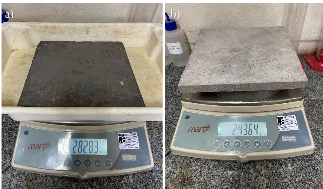
Figura 27 – Pesagem da placa cimentícia. a) em estado saturado, b) após secagem em estufa. Fonte: AUTORA, 2022.
