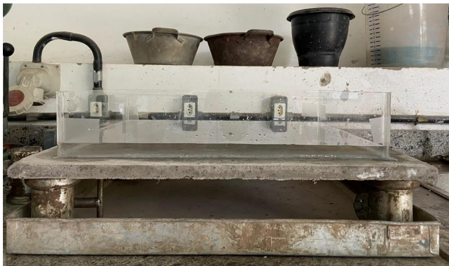
Figura 28 – Ensaio de permeabilidade em placa cimentícia. Fonte: AUTORA, 2022.
